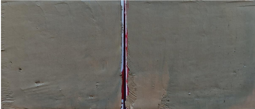
Figur 1 Borrpunkten, 23B08, 3,0 m, Jordprovet i nedre delen av mellanhylsan delad longitudinellt provhylsan med id Bjerking 368.
