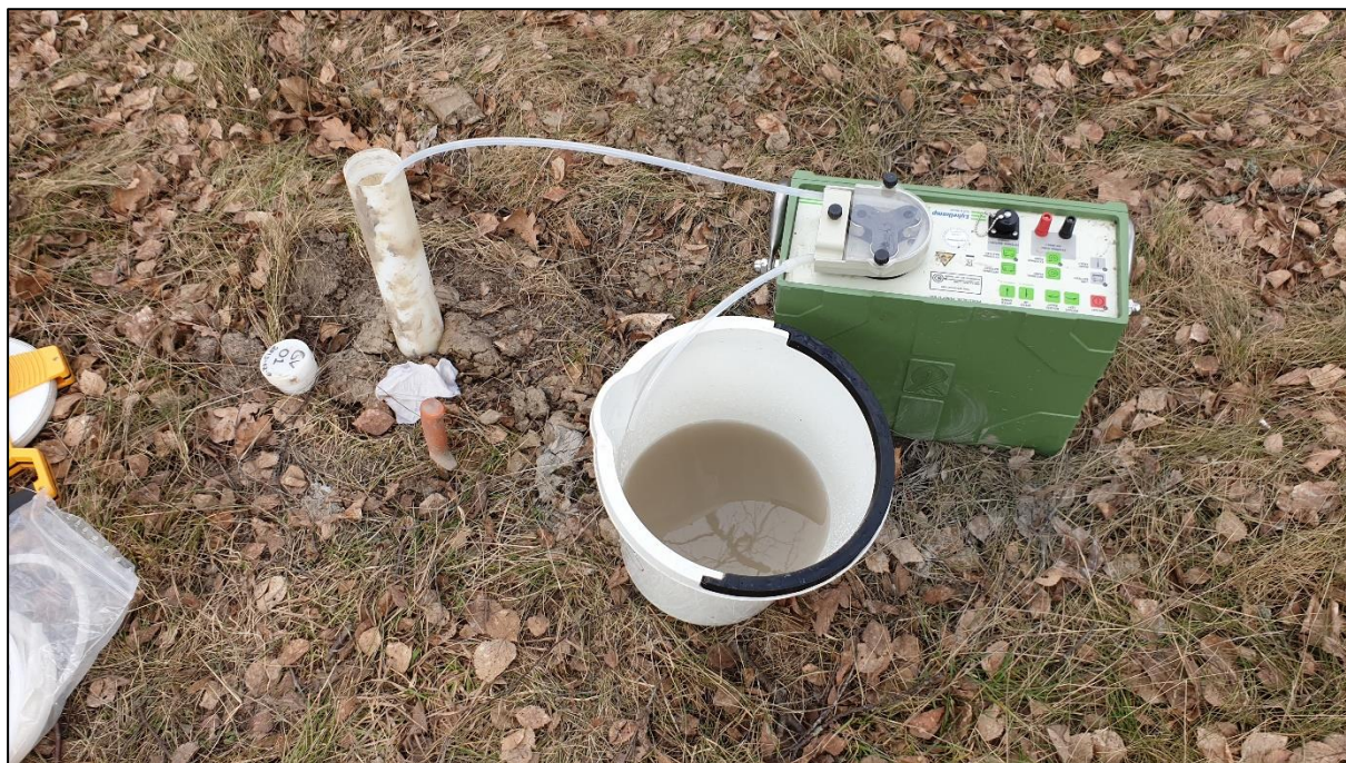
Figur 5. Omsättning av grundvatten i GV01 varefter grundvattennivån fick stabiliseras och grundvattenprov uttogs.
