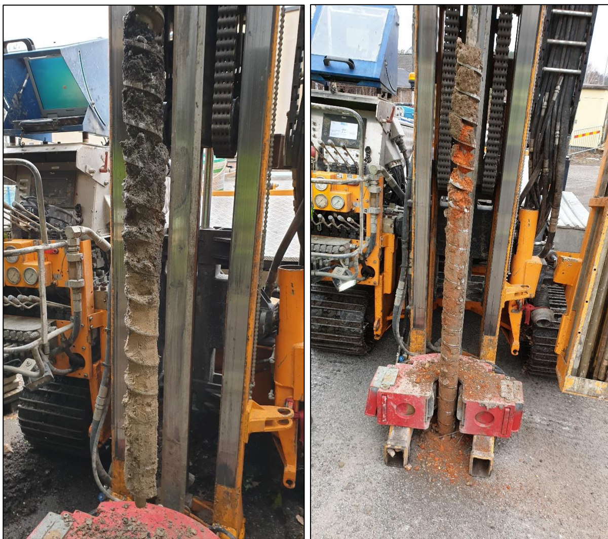
Figur 4. Provtagning av jord med borrhandsvagn vid provtagningspunkt Skr07 (till vänster) och vid provtagningspunkt Skr03 (till höger).
