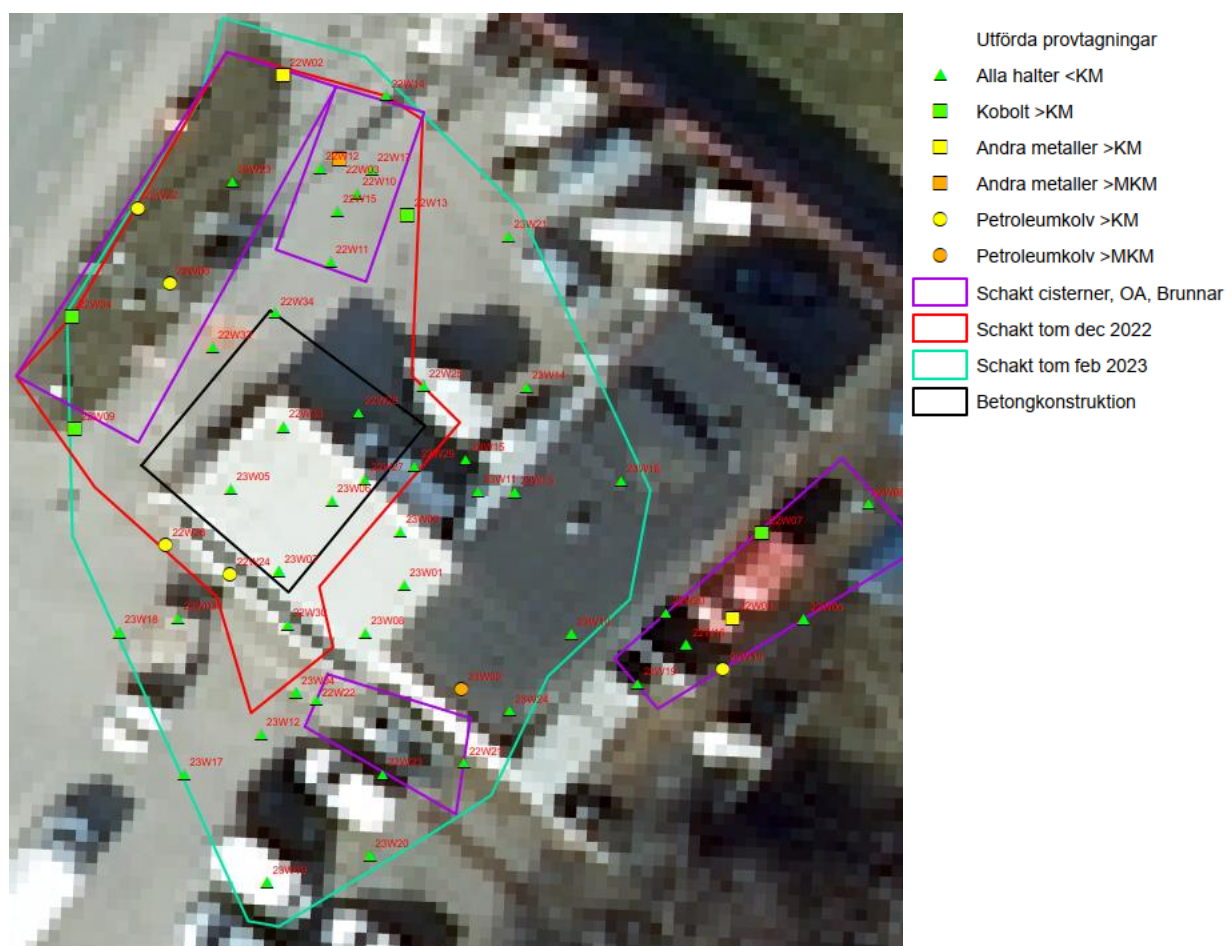
Figur 10: Schaktat och sanerat område inom ramen för efterbehandling av förorenad jord vid f.d. Din-X (WSP; 2023a). Turkos linje visar slutlig avgränsning.
